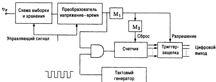
Рис. 6.1. АЦП, на основе преобразователя напряжение-время.
