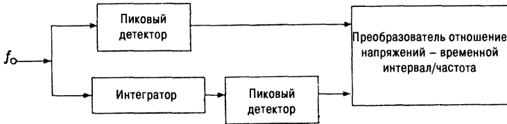
Рис. 3.18. Структурная схема для измерения низкой частоты синусоидального сигнала.
