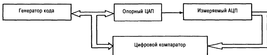
Рис. 6.34. Схема измерения параметров ХП АЦП.
