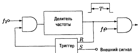
Рис. 3.3. Схема для измерения отношения двух частот.
